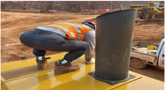
휠도저 상부 안전펜스 미설치 _ 추락 위험
